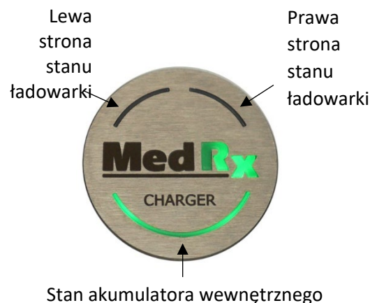
Diody LED ładowarki MedRx wskazują stan akumulatorów
