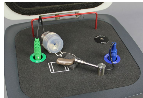
Слуховой аппарат с ресивером в канале (RIC)
